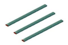
Barramento chato fabricado com cobre e protegido com banho de estanho, para uso exclusivo com os Grampos de Conexão e Suportes para Barramento. Fornecido em barras com um metro de comprimento, possui formato retangular nas medidas de 3 mm de altura por 10 mm de largura e capacidade de corrente de 140 A. A sua utilização enquadra-se dentre as exigências de normas técnicas internacionais para diversas aplicações.
