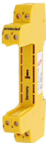
Blitzductor - Base Base Universal para DPS de sinais plugáveis modelo Blitzductor. Extremamente compacto Terminal de 4 pólos para inserção dos módulos de proteção, com (BSP BAS 4) e sem (BXT BAS) Interrupção de sinal na remoção do módulo. Mecanismo snap-in no pé da base permite que o módulo de proteção seja seguramente aterrado através do trilho DIN. Livre de Manutenção. A manutenção é requerida somente para os módulos.
