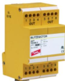
BVTRS485 Protetor de surto para uma vasta gama de aplicações, como utilização em interfaces balanceadas de quatro fios RS485/422 ou sensores de temperatura. Pode ser ligado ao terra do blindagem direta ou indireta, ligação de um sinal terra (SG). Proteção rentável das linhas de sinal multi-core, Versões específicas da interface, p. TTY, RS485, Sistemas de telecomunicações e versões para D.C. Sistemas de alimentação.
