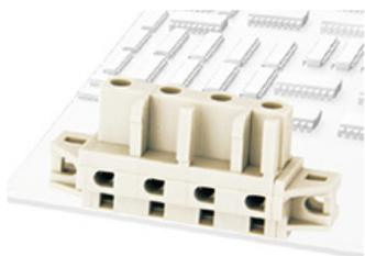
Os Conectores plugáveis da Série 8EDG são conhecidos por oferecerem uma grande vantagem na manutenção de placas eletrônicas, pois não é necessário a remoção de cabo por cabo, bastando apenas a remoção do plugue fêmea ou macho. Os plugues fêmea, também poderão ser fixados diretamente nas Placas de Circuito Impresso e estão disponíveis em diversos passos (ou Pitch).
