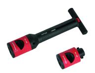
HVISTRIP20 Ferramenta para decapar a isolação dos condutores HVI com diâmetro de até 20mm. Contendo um cabo e várias pontas de corte que podem ser trocadas. Medida de decape ajustável com variação de 0.2mm entre elas usando a alavanca do cabo. O mostrador no cabo indica qual a medida de decape escolhida.
