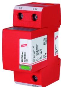
DBM 1 255 (FM) Dispositivo de proteção contra raios, constituído por uma peça de base e um módulo de proteção plug-in. Não corre nenhum disparo de 32 A gG até correntes de curto-circuito de 50 kArms. A sua capacidade de descarga é de até 50 kA (10/350  $\mu$ s). Pode ser utilizado com os dispositivos de proteção contra surtos DEHNguard, o seu nível de proteção é para baixa tensão. Fácil substituição de módulos de proteção sem ferramentas devido ao módulo de bloqueio do sistema com módulo.
