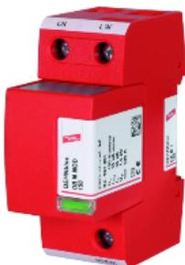
DBM 1 320 (FM) Dispositivo de proteção contra raios, constituído por uma peça de base e um módulo de proteção plug-in. Não corre nenhum disparo de 32 A gG até correntes de curto-circuito de 50 kArms. A sua capacidade de descarga é de até 25 kA (10/350  $\mu$ s). Pode ser utilizado com os dispositivos de proteção contra surtos DEHNguard, o seu nível de proteção é para baixa tensão. Fácil substituição de módulos de proteção sem ferramentas devido ao módulo de bloqueio do sistema com módulo.
