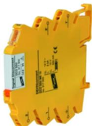
DCOSD2MD Borne de passagem com proteção contra surto integrada, utilizado para proteger os circuitos de medição e de controle e os bus system. Possui capacidade máxima de carga de impulso  $I_{max}$  até 20 kA (8/20  $\mu$ s) Nível de proteção de baixa tensão é capaz de proteger equipamentos finais. Possui função de desconexão modular, onde a desconexão desliga o circuito de sinal para trabalhos de manutenção. Seu design gera economia de espaço e otimização de funções, com largura de 6 mm.
