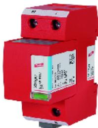
DGP M 255 Protetor de corrente especialmente concebido para instalação em configurações 3 + 1 e 1 + 1 de sistemas TT. De acordo com IEC 60364-5-53 entre o neutro N e o condutor de proteção PE, Capacidade de descarga até 100 kA (10/350 ?s)
