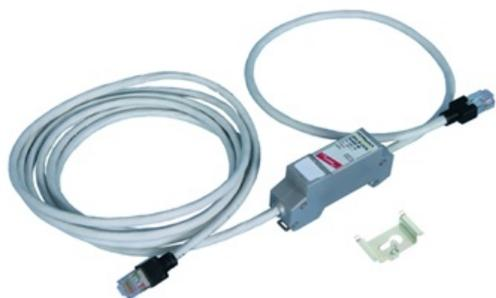
DPA M CAT6 RJ45S 48 Protetor de Surto para Industrial Ethernet, Power over Ethernet (PoE + de acordo com IEEE 802.3at até 57 V) e aplicações semelhantes em sistemas de cabeamento estruturado de acordo com Cat. 6 e classe EA até 500 MHz. Modelo totalmente blindado Cabo de conexão para montagem em trilho DIN (até 10 Gbit Ethernet). Acessórios: Suporte de ligação à terra com manga de ligação plana
