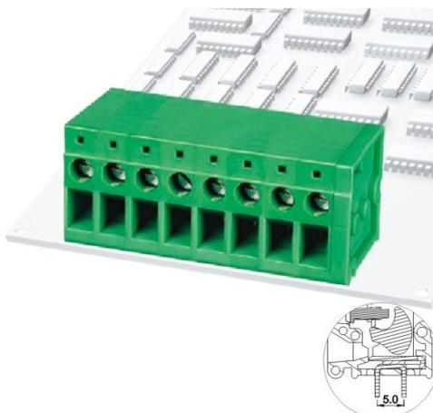
Os bornes para placa de circuito impresso com conexão a parafuso DG105 dispõem de uma conexão frontal sendo a aplicação ideal para os casos onde o sentido de acionamento e a entrada de cabos deve estar no mesmo nível. Estes bornes dispõem de uma ampla diversidade do número de vias e passos de 5,0 mm ou 7,5 mm. \*Modelos Disponíveis de 1P-xxP polos. (Pode ser Montado) Caso não tenha na listagem de produtos, consultar nosso setor de vendas.
