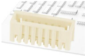
Os Conectores plugáveis da Série 8EDG são conhecidos por oferecerem uma grande vantagem na manutenção de placas eletrônicas, pois não é necessário a remoção de cabo por cabo, bastando apenas a remoção do plugue fêmea. Os plugues macho/fêmea, também poderão ser fixados diretamente nas Placas de Circuito Impresso e estão disponíveis em diversos passos (ou Pitch).
