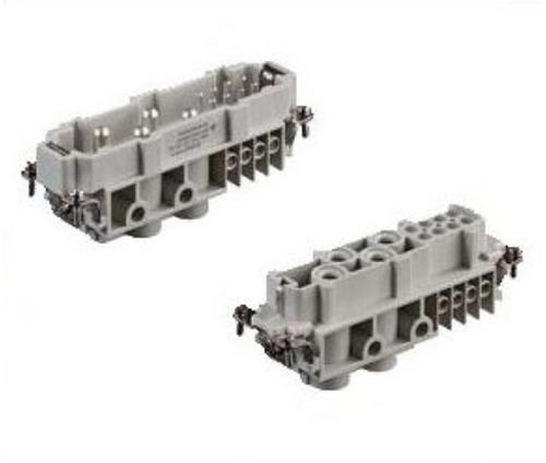
Os insertos da Série HK integram numa única peça conexões elétricas de controle e potência, com contatos de valores diferentes. Os insertos podem incorporar os contatos com terminação axial, contato por parafuso ou contatos de crimpar, sendo os últimos fornecidos separadamente. Os insertos são produzidos em poliamida com resina plástica auto-extinguível UL94 V0, material isolante que suporta altas temperaturas e possui excelentes propriedades elétricas, mecânicas e químicas.
