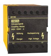
ISOMETER - AGH150 Acopladores são necessários para aumentar a tensão nominal de equipamentos da linha ISOMETER. O Acoplador é conectado no sistema a ser monitoramento por 2 polos e conectados ao ISOMETER. Esse acoplador aumenta a tensão nominal para AC 1150 V e DC 1760V. Aplicável em instalações que possuem alta tensão. Aplicável na linha de produtos ISO685.
