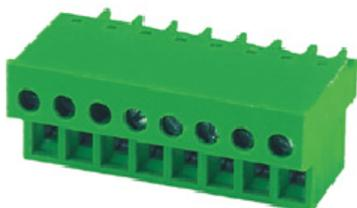
Os Conectores plugáveis da Série EDG são conhecidos por oferecerem uma grande vantagem na manutenção de placas eletrônicas, pois não é necessário a remoção de cabo por cabo, bastando apenas a remoção do plugue fêmea. Os conectores macho, também conhecidos por "HEADER", são fixados diretamente nas Placas de Circuito Impresso e estão disponíveis em diversos passos (ou Pitch). \*Modelos Disponíveis de 2P-24P polos. Caso não tenha na listagem de produtos, consultar nosso setor de vendas.
