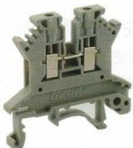
MINI BORNE PARAFUSO 2.5 Conexão Parafuso Cor Cinza Os minibornes são indicados para os casos onde há necessidade de redução do espaço interno dos painéis. Construído com materiais plásticos isolantes de alta tecnologia, recebe reforço de fibras de vidro e aditivos retardadores de chamas que oferece excelente resistência a altas temperaturas. Produto conforme especificação IEC 60947-7-1. Grande número de acessórios disponíveis, como: Jumpers externos; Pontes conectoras; Tampas.
