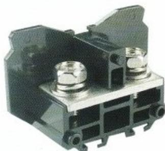
Conectores de potência elevada para terminais do tipo olhal redondo com arruelas de travamento para assegurar excelente capacidade de aperto dos condutores. A junção do corpo com a base do borne é feita através de dois longos parafusos, oferecendo boa estabilidade do conjunto e opção de fixação direta na placa de montagem, sem a necessidade de trilhos DIN. As características técnicas apresentadas correspondem à norma IEC 60947-7-1.
