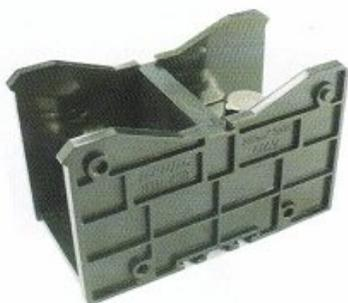
Conectores de potência elevada para terminais do tipo olhal redondo com arruelas de travamento para assegurar excelente capacidade de aperto dos condutores. A junção do corpo com a base do borne é feita através de dois longos parafusos, oferecendo boa estabilidade do conjunto e opção de fixação direta na placa de montagem, sem a necessidade de trilhos DIN. As características técnicas apresentadas correspondem à norma IEC 60947-7-1.
