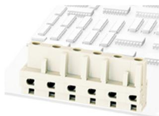
Os Conectores plugáveis da Série 8EDG são conhecidos por oferecerem uma grande vantagem na manutenção de placas eletrônicas, pois não é necessário a remoção de cabo por cabo, bastando apenas a remoção do plugue fêmea ou macho. Os plugues fêmea, também poderão ser fixados diretamente nas Placas de Circuito Impresso e estão disponíveis em diversos passos (ou Pitch). \*Modelos Disponíveis de 2P-12P polos. Caso não tenha na listagem de produtos, consultar nosso setor de vendas.
